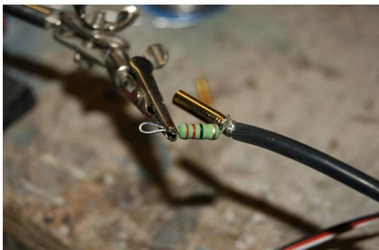
Als erstes wird eine Seite zu einer Schlaufe gebogen. Anschließend das andere Ende des Widerstandes gekürzt und am Stecker angelötet. Die Schlaufe muss etwas länger wie der Stecker sein.
