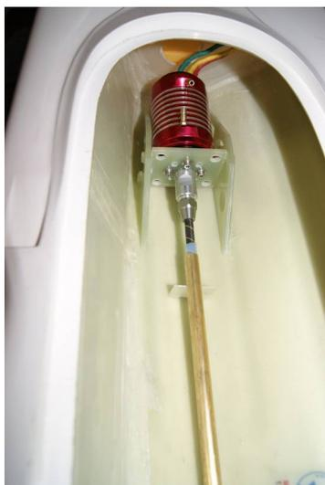
Nachdem das Teflonrohr im Stevenrohr verschwunden war, konnte auch die Flexwelle installiert werden. Damit ist der Antrieb erledigt.
