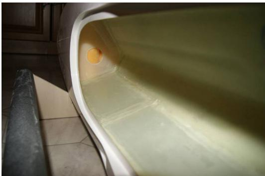
Danach noch die zweite Hälfte des Flutkanals eingeklebt und die Nahtstelle zwischen den Flutkanalhälften mit Nahtband verstärkt.
