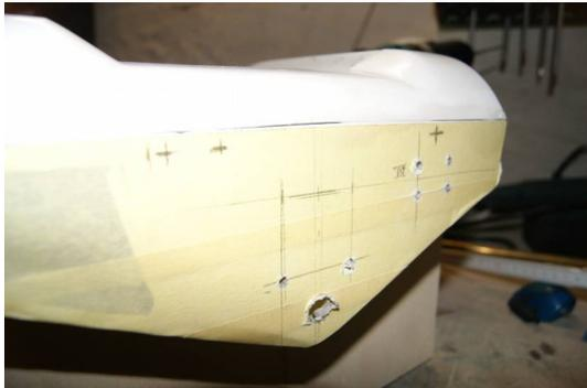
**Schritt 9:** Nachdem der Flutkanal nun dicht ist (hierbei ist Nahtband ganz hilfreich – würde den nächsten Flutkanal nur mit Nahtband einkleben) kann wieder gebohrt werden. Den Heckspiegel zuerst mit Maler-Krepp beklebt. Nun die Anbauteile angezeichnet und die Löcher gebohrt. Für Gestänge- und Wasserdurchführung Messingrohr abgesägt.
