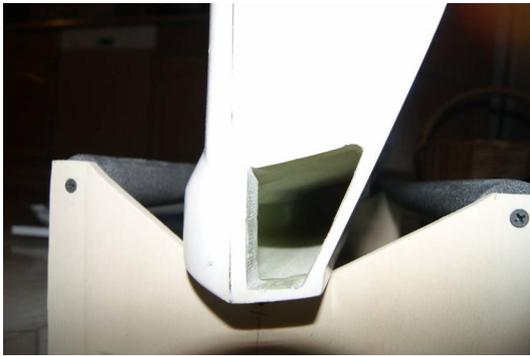
**Schritt 8:** Jetzt stand das Öffnen des Flutkanals an. Dafür musste ein Bautrupp mit starkem Gerät angefordert werden. Man sollte bei dem Schritt 6 etwas sparsamer mit dem Harz umgehen, sonst muss gesprengt werden. Also Bohrmaschine geschnappt und aufgefäst. Anschließend mit grober Feile weiter geöffnet und nachbearbeitet. Mit dem Ergebnis bin ich ganz zufrieden (das Boot ist jetzt auch wieder um 1 Kilo leichter...).
